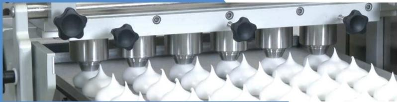
Rodillos de dosificación e boquillas en acero inox
